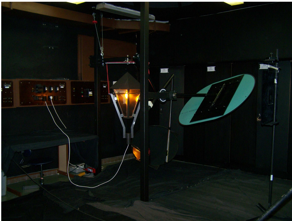
Obr.4: Konštrukcia nového goniofotometra
