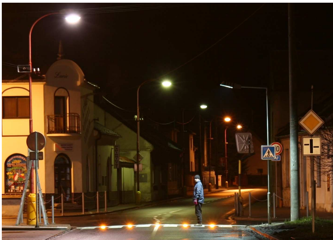
Obr. 3 – reálné foto v noci při rozsvícených LED svítidlech a rozsvíceném VO (osvětlenost přechodu cca 160 lx)
