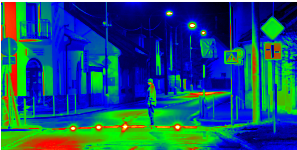
Obr. 2 – jasová mapa nočního měření při rozsvícených LED svítidlech a rozsvíceném VO (osvětlenost přechodu cca 160 lx), modrá barva – malé jasy, zelená barva – střední jasy, červená barva – vysoké jasy, bílá barva – jasy světelných zdrojů
