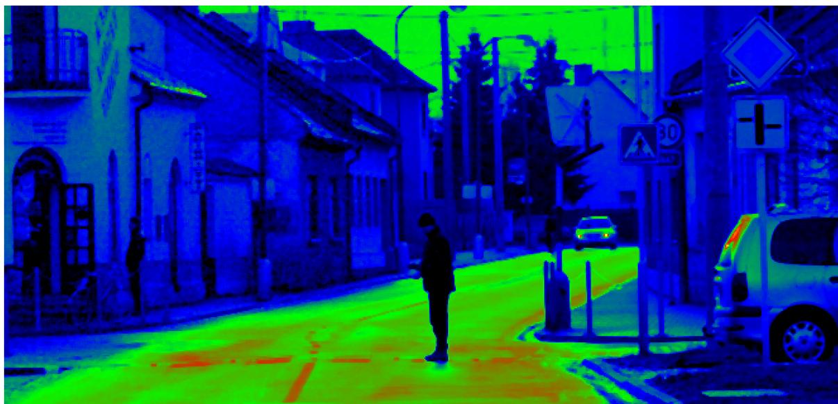
Obr. 1 – jasová mapa měřeného přechodu za dne (osvětlenost komunikace cca 2 klx) při rozsvícených LED svítidlech, modrá barva – malé jasy, zelená barva – střední jasy, červená barva – vysoké jasy
