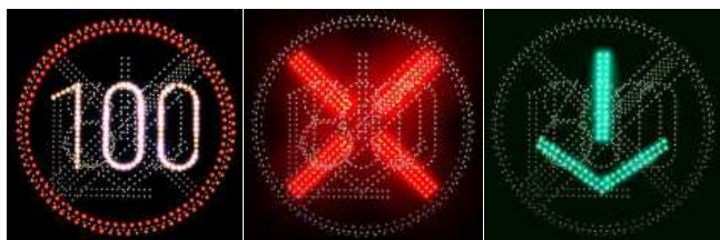
Obr. 3 Příklady symbolů dopravních značek tvořených optickými prvky s LED na matici PDZ
